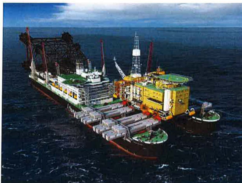
Imagen 13: Posible alternativa de desmontaje sin HLV. EL buque Pioneering Spirit portando un topside en su proa y la jacket en su popa.
